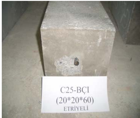
Şekil 5.8. C25-BÇI-Etriyeli numune örneği.
