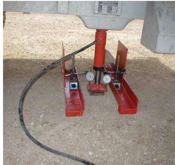
Şekil 2. Plaka yükleme deney düzeneğinin bakir toprak-zemin üzerinde deneye hazır durumdaki görüntüsü.
