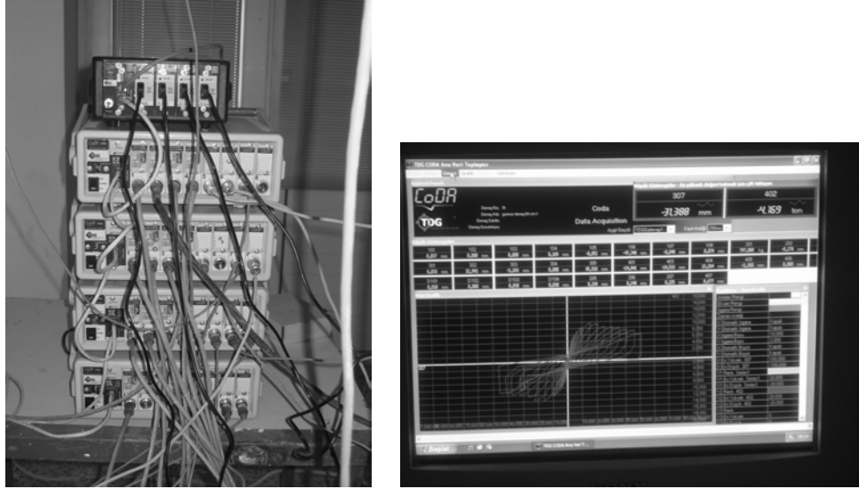
Şekil 5. Yük ve yer değiştirme okumalarını değerlendiren veri aktarım sistemi.
