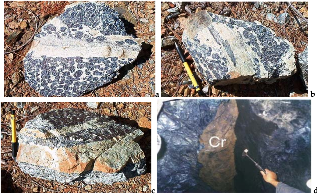
Şekil 5. Andızlık kromit ocağına ait cevher örnekleri, a) saçınımlı, benekli ve masif kromit, b) benekli ve katmansı kromit, c) katmansı kromit, d) 1166 galerisindeki katmansı kromit.
