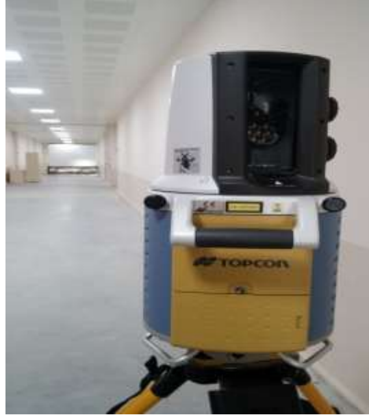
Şekil 8. Test alanının dik olarak taratılması
