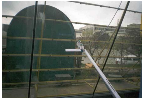
Şekil 7. Strüktürel dayanım deneyinde sapma miktarlarının ölçülmesi. Figure 7. Measurement of deviation amount at structural testing.
