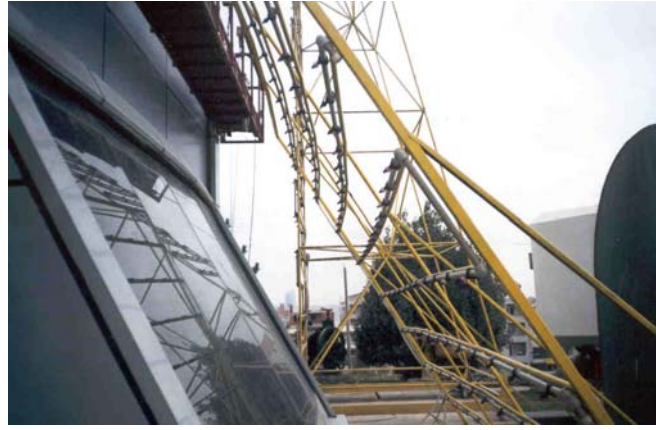
Şekil 5. Su geçirimsizlik deneyinde kullanılan yağmurlama sistemi. Figure 5. The rain system used at the watertightness testing.
