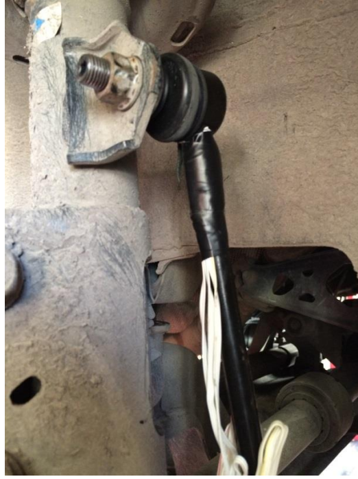
Şekil 3. Strain-gage bağlanmış parçanın araca bağlanması
