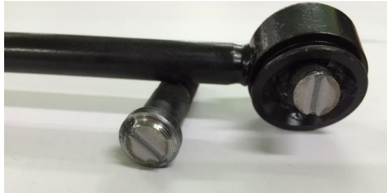
Şekil 9. Testin sonunda kırılan numune örneği
