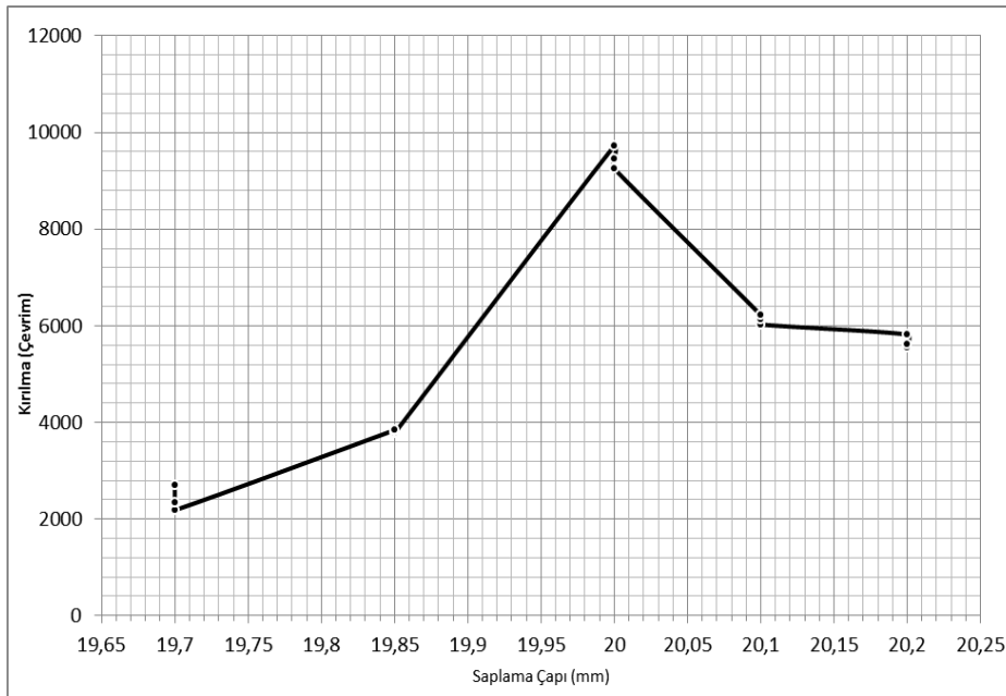
Şekil 10. Test sonuçlarına göre farklı çaptaki kürelerin kırılma çevrimlerini gösteren grafik
