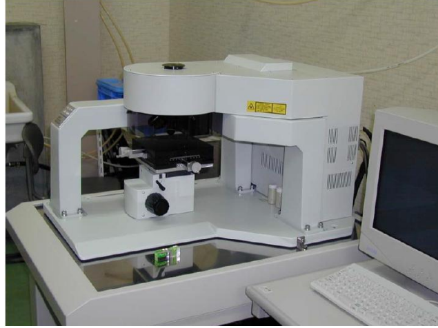
Şekil 4. Konfokal lazer tarama mikroskobu (Chae ve diğ., 2004) ( Confocal laser scanner microscope (Chae et al., 2004) )
