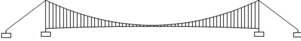
Şekil 2 :Fatih Sultan Mehmet Köprüsü'nün iki boyutlu sonlu eleman modeli.
