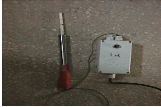
Resim 4. Deneylerde kullanılan yer değiştirme ölçüm sistemleri.
