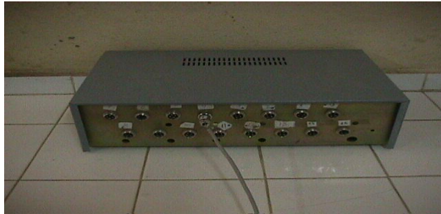
Resim 5. Yük ve yer değiştirme okumalarını değerlendiren data logger sistemi.
