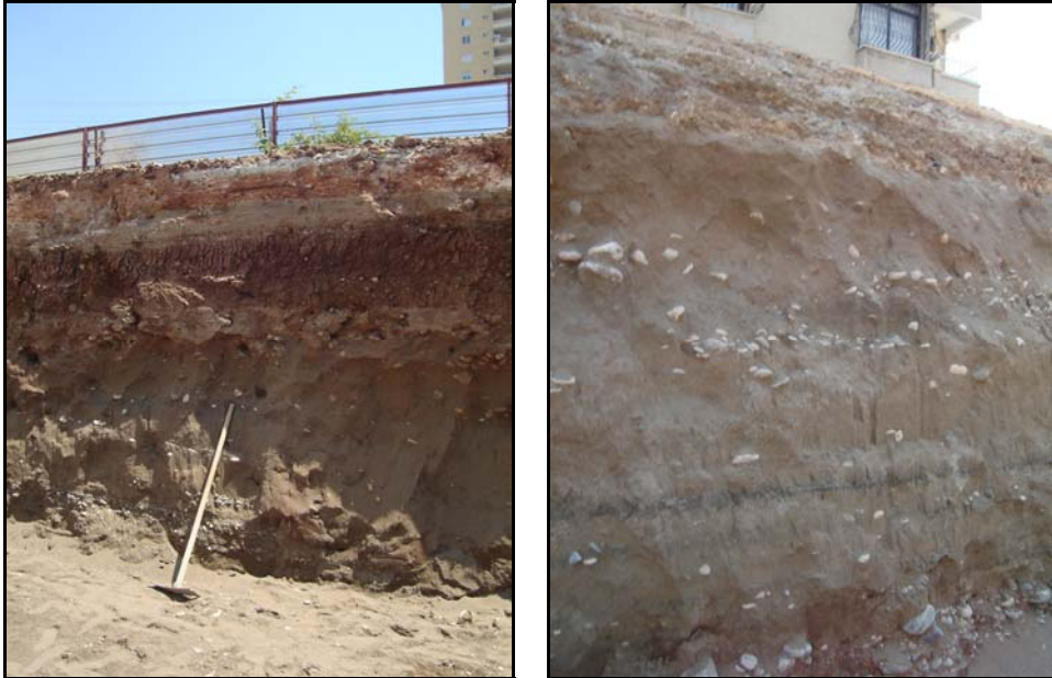
Şekil 8. SPT darbe sayılarında yüksek değerlerin elde edilmesine neden olan iri çakılların kumlu birim içerisindeki düzensiz dağılımı.
